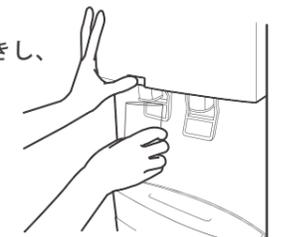
**9** 冷水・温水コックより出水されたことを確認後、電源プラグをコンセントに差し込む
