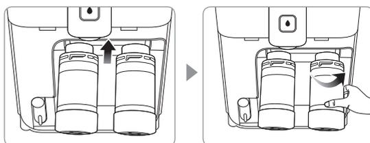
3. 交換する新しいフィルターの種類を間違わない様に順にセットし、右回りに回してフィルターを取り付けた後、フィルターを下に下ろしてください。
