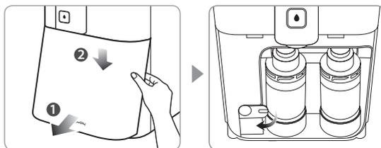
2. フィルターを前面の上に引き上げてから、使用済のフィルターを左回りに回して抜き取ります。
