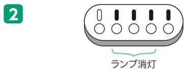
2 温水・常温水・冷水ランプが消灯したら完全ロックになります。
