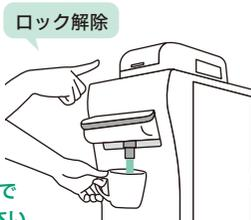
再加熱中に他のボタンを押すと再加熱は止まります。再加熱を続けたい場合は、もう一度操作をやり直してください。
